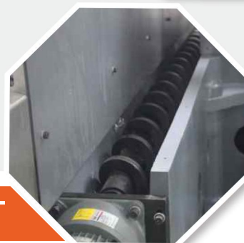
自動チップ排出コンベヤー Automatically remove chips
